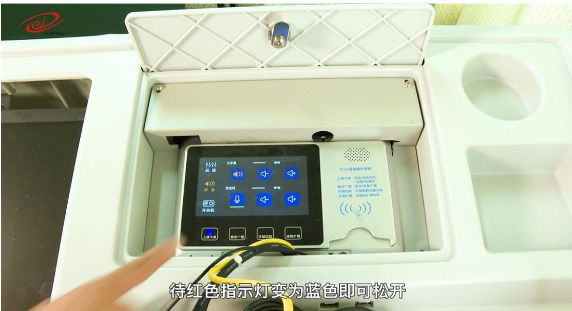
2、**主音量**及**话筒音量**在**中控面板**上选择**声音**，用“+”、“-”按键进行调节。
